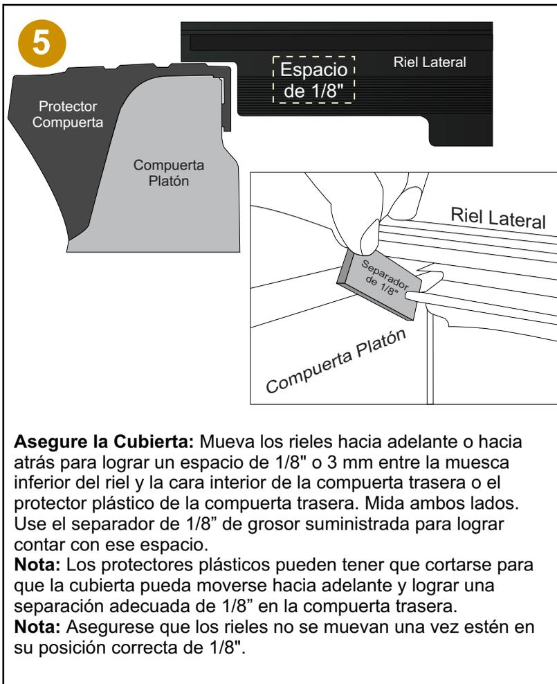
**Asegure la Cubierta:** Mueva los rieles hacia adelante o hacia atrás para lograr un espacio de 1/8" o 3 mm entre la muesca inferior del riel y la cara interior de la compuerta trasera o el protector plástico de la compuerta trasera. Mida ambos lados. Use el separador de 1/8" de grosor suministrada para lograr contar con ese espacio.
