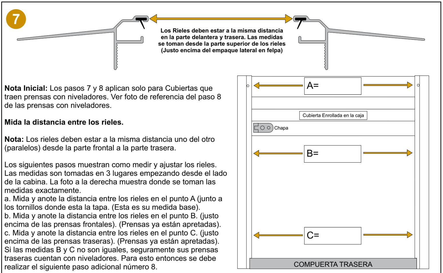
**Nota Inicial:** Los pasos 7 y 8 aplican solo para Cubiertas que traen prensas con niveladores. Ver foto de referencia del paso 8 de las prensas con niveladores.
